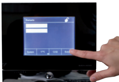
Touchpanel BUS-System, komplette Haus- elektrik mit ein paar Handgriffen navigierbar!
